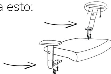
5) Unir el espaldar a la silla con los tornillos indicados. Esta unión se encuentra en el lado superior del respaldo de la Silla:
