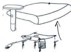
2) Adicional la estructura de la silla tipo Trineo al asiento. Realizar este proceso con los tornillos asignados para esto:
